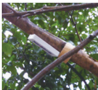
センサユニットの樹木への 取り付けの様子
