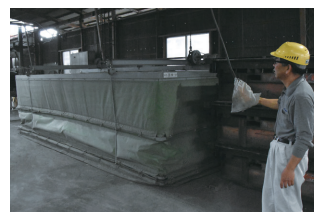
導入した吊り下げ養生槽
