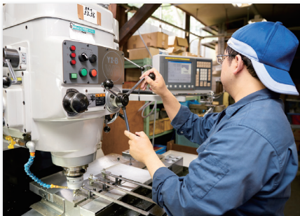
1回のセットで最大6個まで削れるため大幅な効率化ができた
