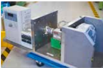
トルクメーターで、所定のトルクが出ているか修理の前後で確認できるようになった
