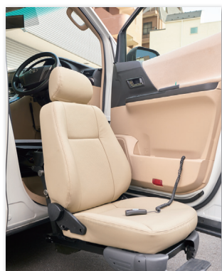
運転席のシートも車椅子からの移動が可能な高さまで動く
