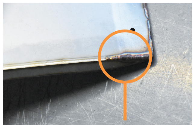
ステンレス製の曲面デザインのことを溶接したサンプル
