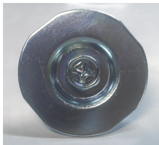
良品 純度の高い水洗水にて十分に洗浄されたもの。光沢があり、クロメートの発色も優れている。
