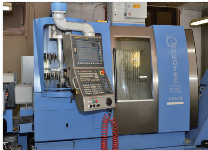
5軸のCNC 制御機械BUMOTEC s-191
