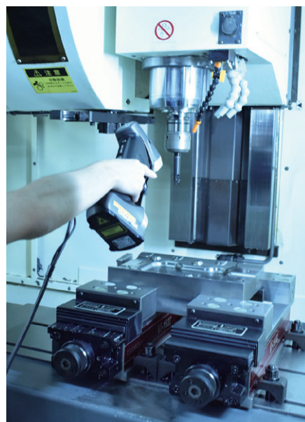
▲加工中のワークを外さずに測定できる
