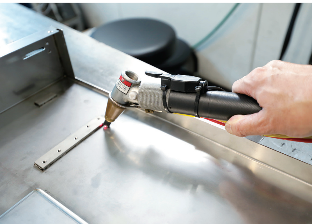
▲ファイバーレーザー溶接機で歪みを整える
