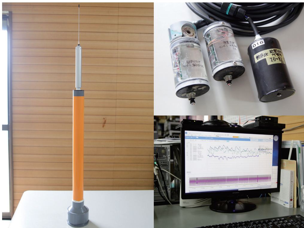
▲子局ブイの試作品(写真左)／本事業で開発したセンサー(写真右上)／海水情報画面。グラフ化も自動で行う(写真右下)
