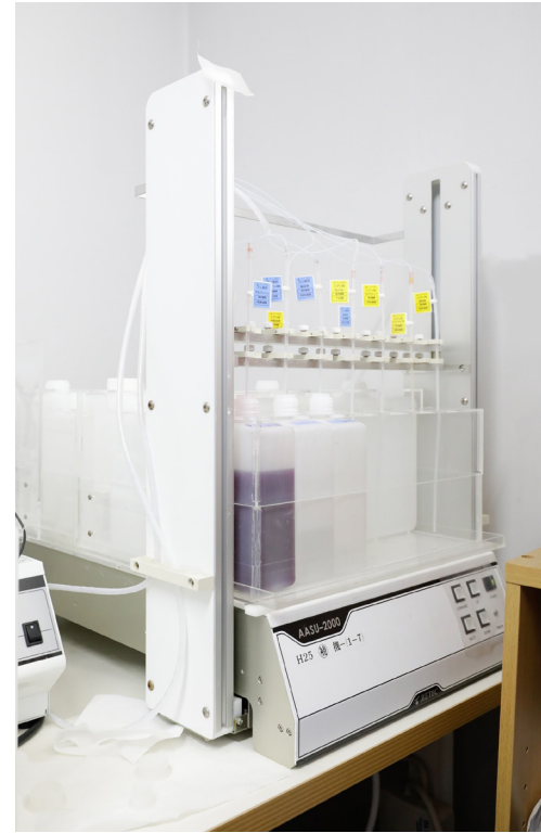
自動洗浄装置により夜間に人がいなくても稼働できる
