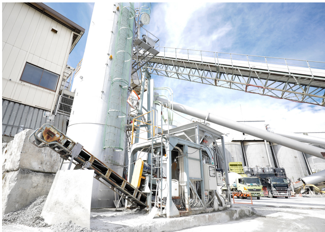
開発した再生コンクリート製造装置 第2プラントと、こんじゃり君
