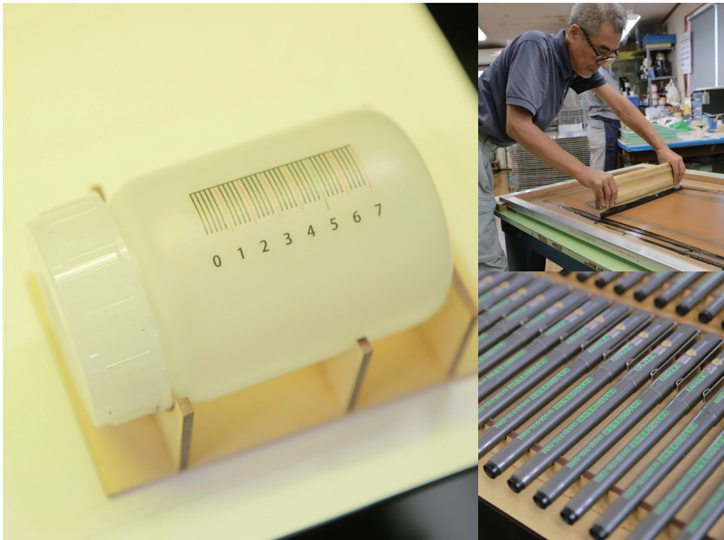
▲インクジェットプリンタでの曲面印刷（写真左）／シルク印刷の作業風景（写真右上）／受け治具で固定された大量の製品たち（写真右下）
