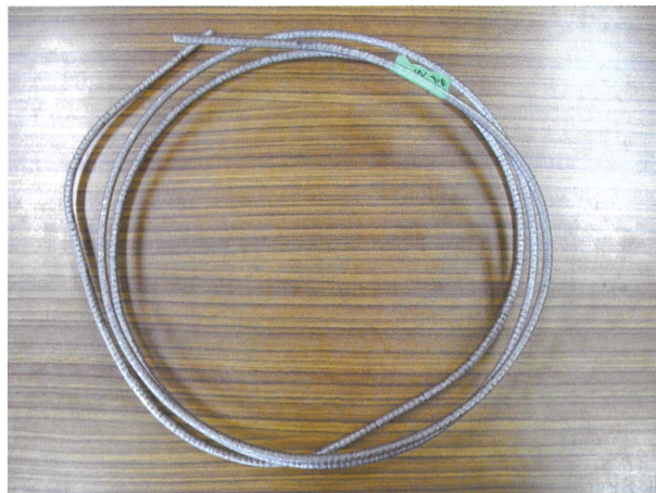
\phi 8\text{mm} の4,000mmの連続鋳造品
