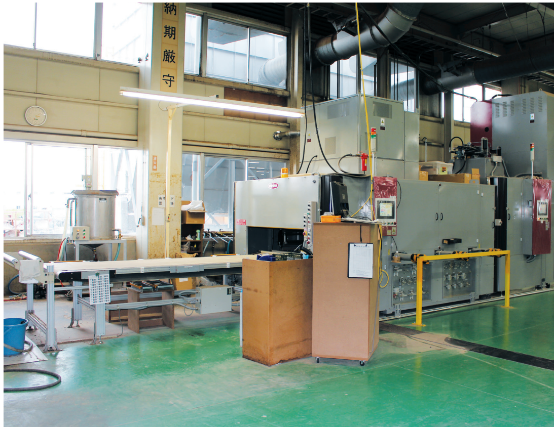
補助金事業で導入した高周波プレス機
