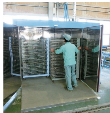
導入された熱風循環式乾燥装置
