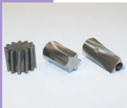
ワイヤー放電加工機で上下異形状に加工した金属 (テストサンプル)
