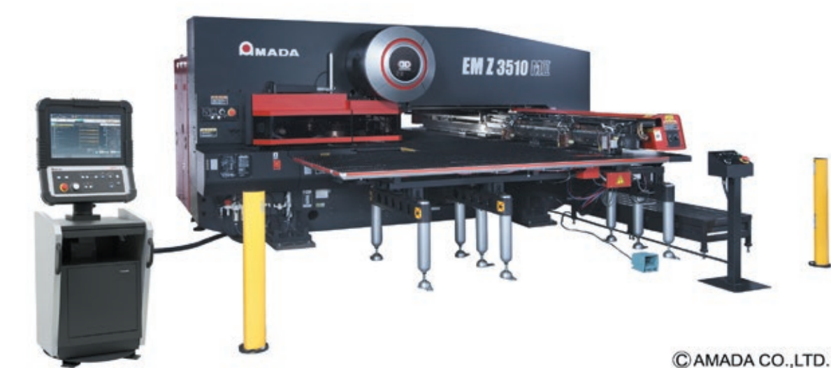
本事業で導入された大型タレットパンチプレス機
