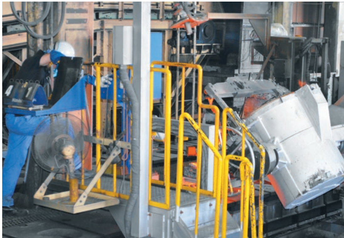
25年度の補助金事業で導入されたPCF自動注湯機
