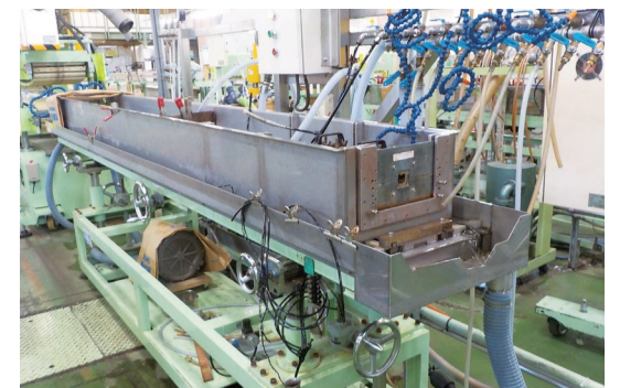
新ラインの冷却水槽
