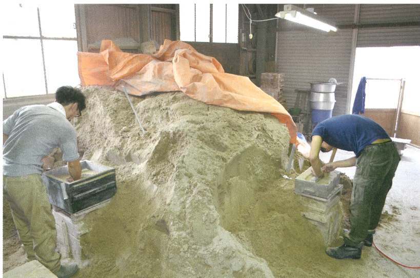
モデリングマシンで制作した樹脂型を使って砂型を製作する鑄造部門の従業員
