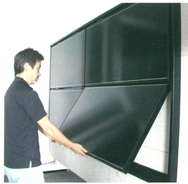
取り付けもメンテナンスもしやすく改善されたフレーム
