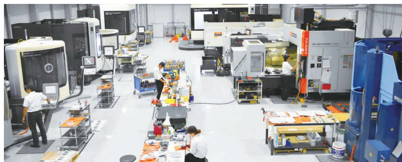
航空機部品専用工場。現在、5軸マシニングセンタなどの大型工作機械が9台稼働し、主翼部品や機体部品を製造している
