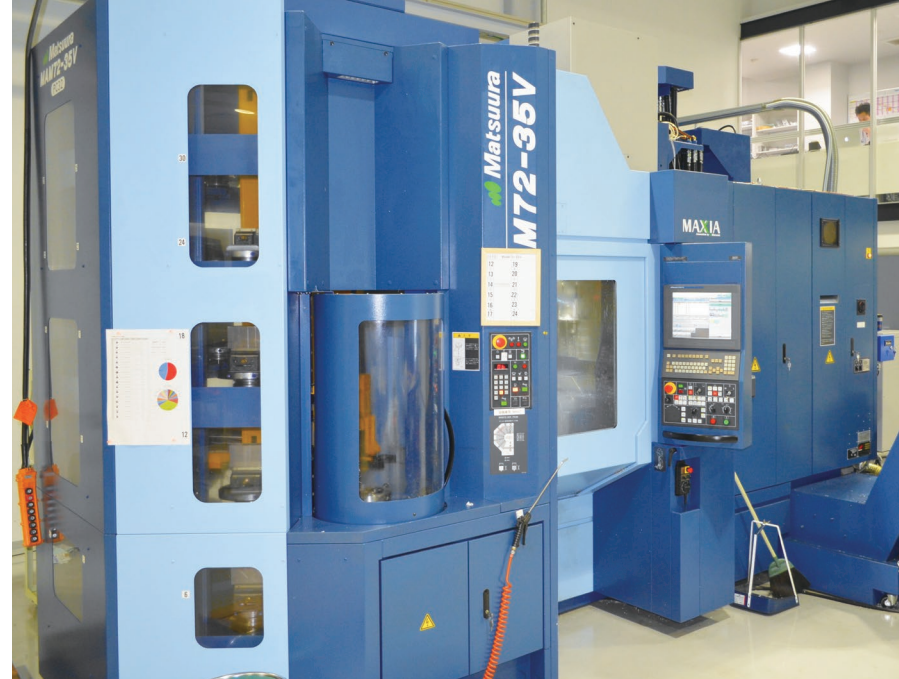
補助金事業で導入された5軸制御立形マシニングセンタ「MAM72-35V」
