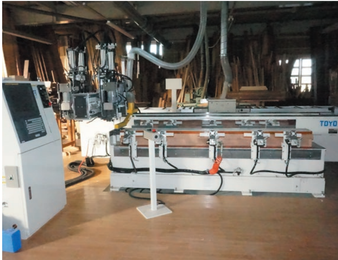
本事業で開発された自動穴加工機「NC角ノミ」
