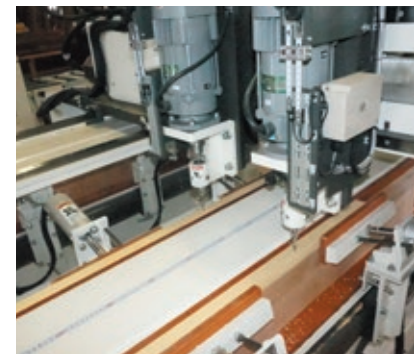
寸法を入力すると自動的に穴加工を行うNC角ノミ
