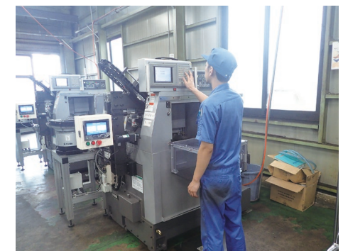
自社開発の自動供給装置と取り付けたNC旋盤
