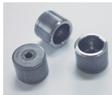
ストッパピストン。 左が旋削前、右が旋削後
