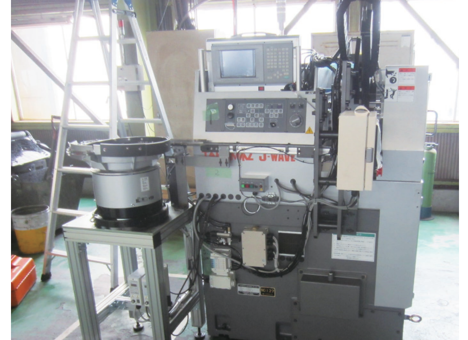
今回導入したNC旋盤と自社開発の自動供給装置
