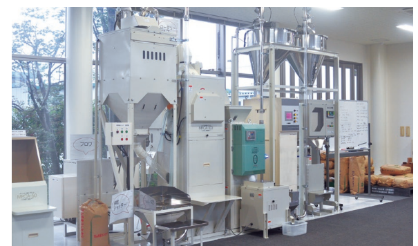
新商品のエア搬送機や精米機を組み合わせた精米計量プラント
