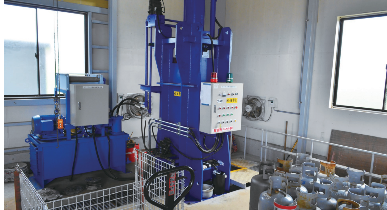
補助金で導入されたLP G 堅型圧縮式減容プレス機
