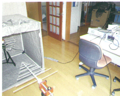
高周波測定器による性能実験
