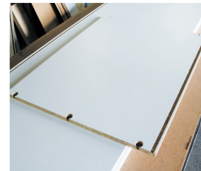
NC加工機で穴開け加工を施したパネル
