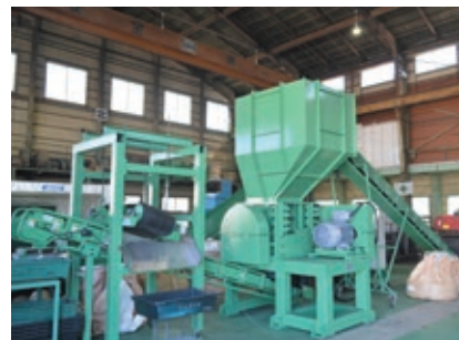
主力製品の「エコセパレ® 分離・破砕機」。廃タイヤやケーブルなど、複雑な異素材混合廃棄物がわずか10秒で分離・破碎・選別される
