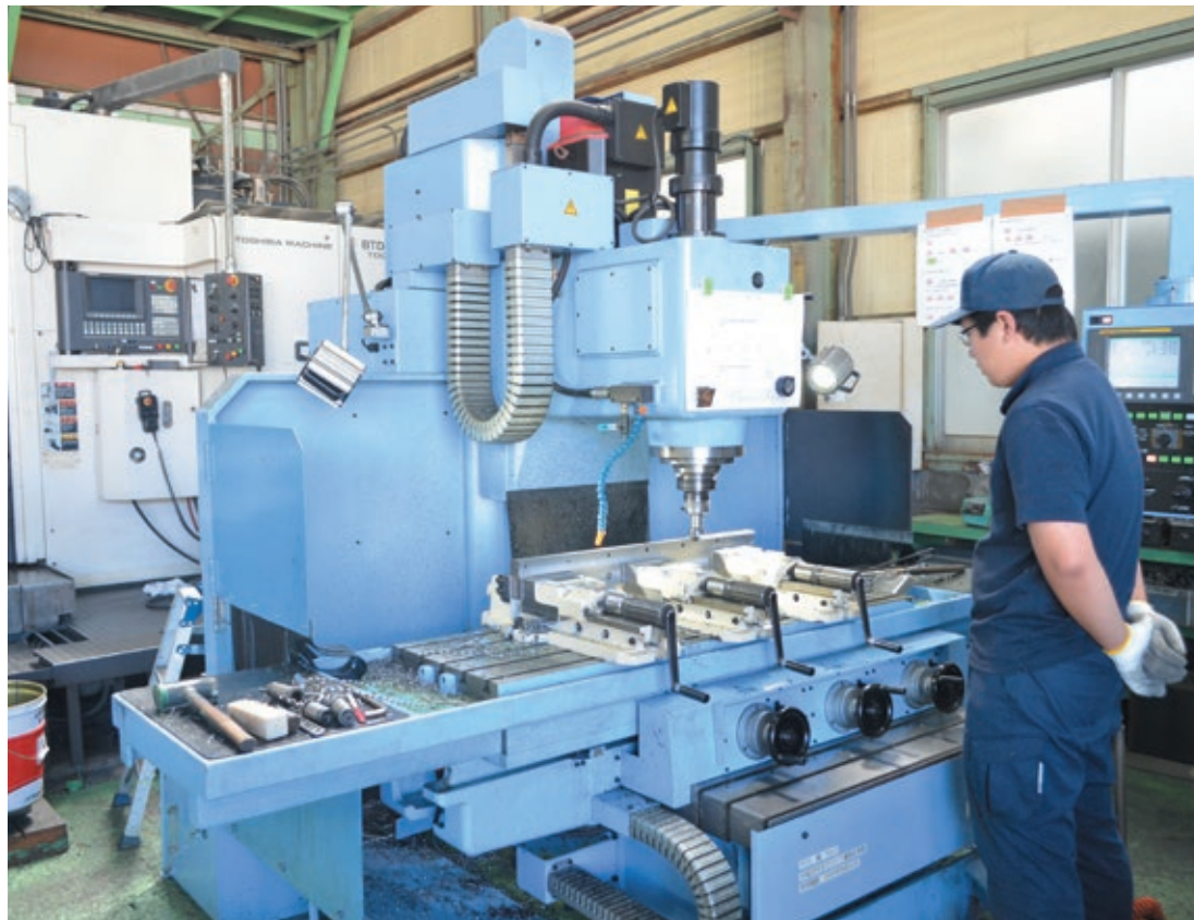
導入された高能率型NC付汎用フライス機
