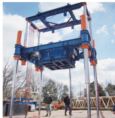
当社のシリンダー（オレンジ部分）を使用した建設・橋梁作業用大型油圧ジャッキ。国内のみならず海外の大型事業でも当社の部品を使ったジャッキが活躍している
