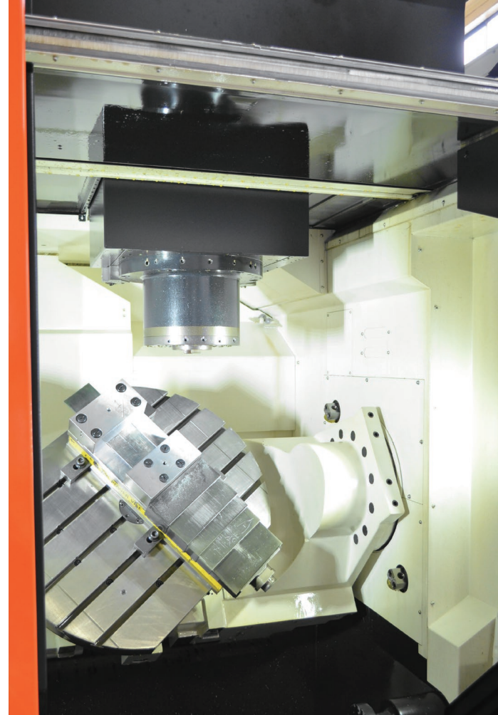
導入された5軸制御立形マシニングセンタ「VARIAXIS I-800」の内部
