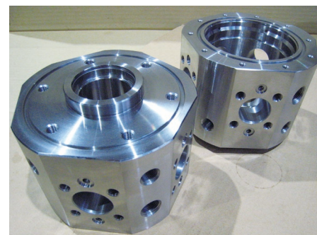
導入設備で加工した製品。1チャックで5面加工でき、加工精度を大幅に向上した
