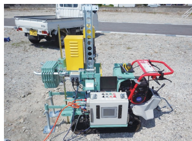
全自動スウェーデン式サウンディング試験機「ウルトラサーチUR-3型 特殊仕様」 空圧荷重制御により自沈層を高精度に測定可能。高トルクの為、専用治具を用いることで碎石層も貫入可能
