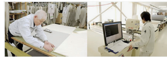
左：従来の職人手作業による裁断 右：CAD/CAMシステム導入後の自動裁断
