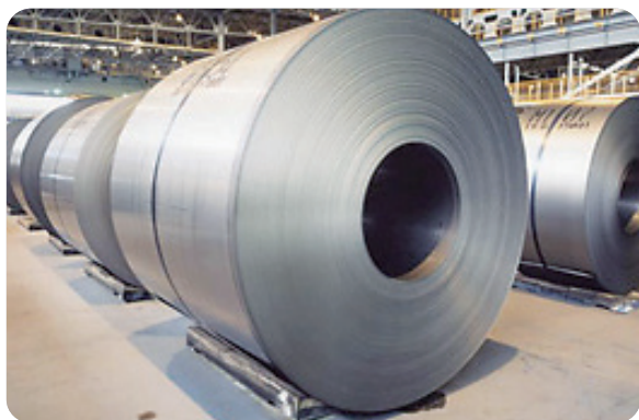
高炉メーカーからの母材薄鋼板コイル
