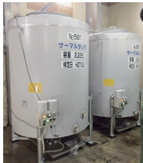
試験用小型サーマルタンク
