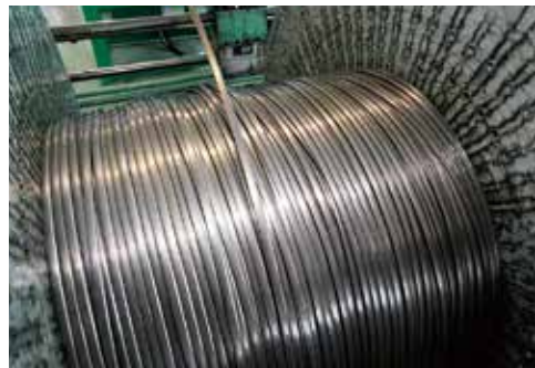
1 高級腕時計のバンドに、同社製のチタン異型線が使用されている。2 連続ロール圧延加工により、従来の生産方式に比べ、リードタイム短縮とともに光沢性の高い異型線(写真下)の製造を実現した。3 連続ロール圧延による加工シーン。4 現在、同社が製造する高級バンド用異型線の半数は、新生産方式に移行している。
