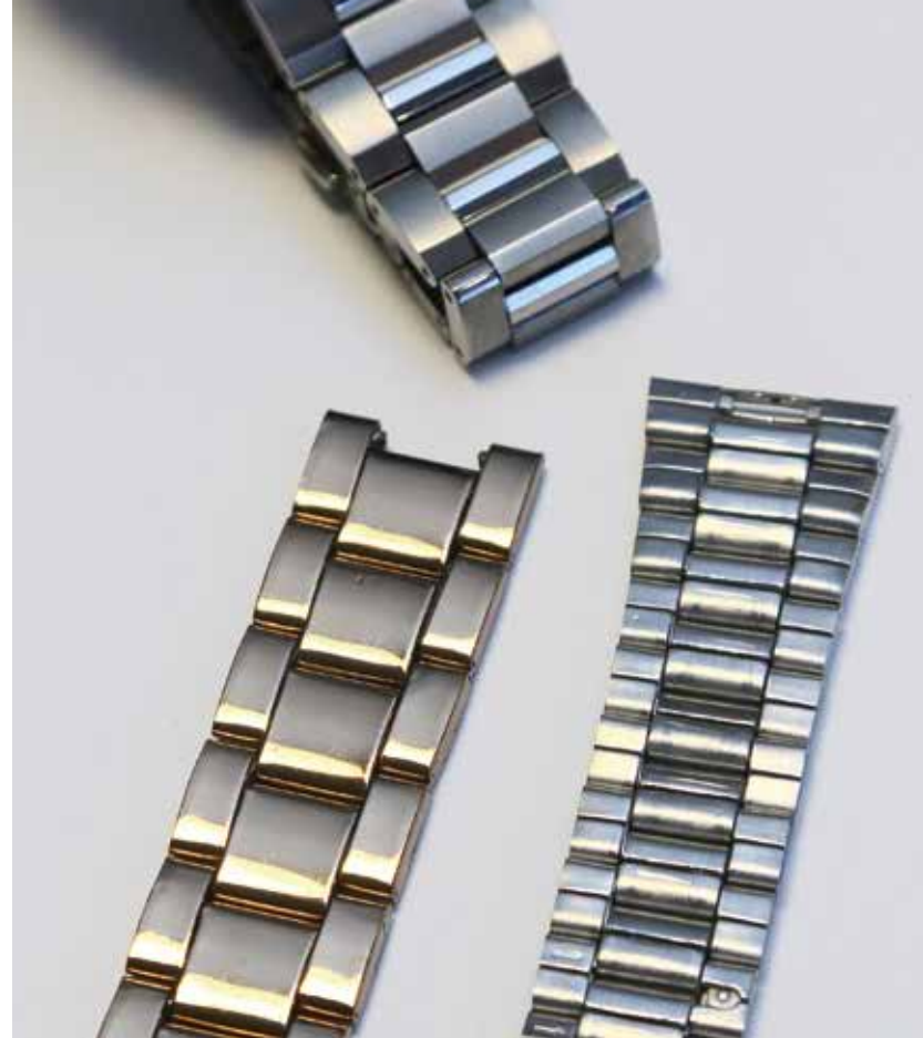
1 高級腕時計のバンドに、同社製のチタン異型線が使用されている。2 連続ロール圧延加工により、従来の生産方式に比べ、リードタイム短縮とともに光沢性の高い異型線(写真下)の製造を実現した。3 連続ロール圧延による加工シーン。4 現在、同社が製造する高級バンド用異型線の半数は、新生産方式に移行している。
