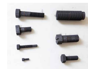
得意としているc/cコンポジットを加工したネジ。
