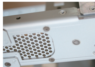
スポット溶接部分
