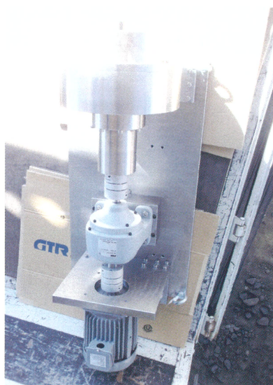
ゼロから開発した蒸気タービン
