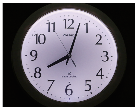
オークが開発したフロントライトを使い、LED1個で全面発光している壁掛け時計
