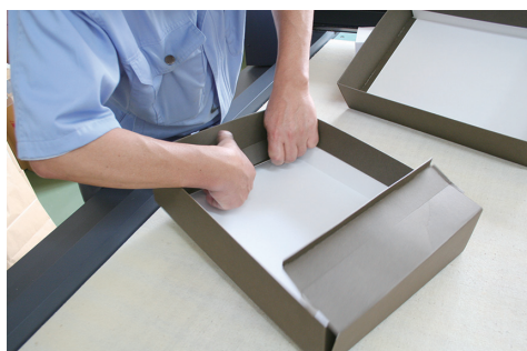
＜C式化粧箱 両長辺を同時に起こすことにより、 簡単な動作で組み立てられる＞
