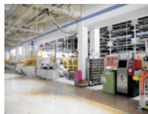
ユニットバスパネルの生産ライン
