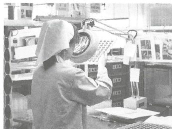
目視による検査工程
