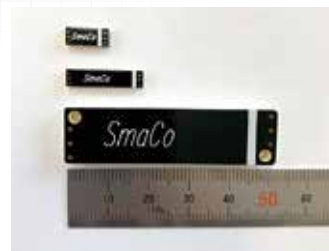
小型・軽量化した金属対応 UHF帯RFタグ（RFID）
