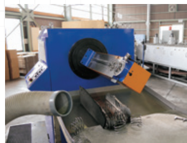
三軸CNCワイヤーフォーミングマシン
