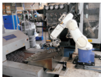
ロボットが活躍するばねの低温焼鈍し工程
