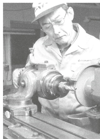
熟練技能者による切削工具の研磨
