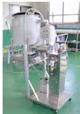
手前：ピストン式充填機 奥：甘酒製造糖化装置
