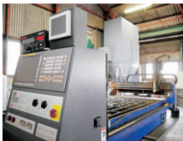
プラズマ切断機
