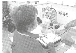
顕微鏡による電子部品の出荷検査
